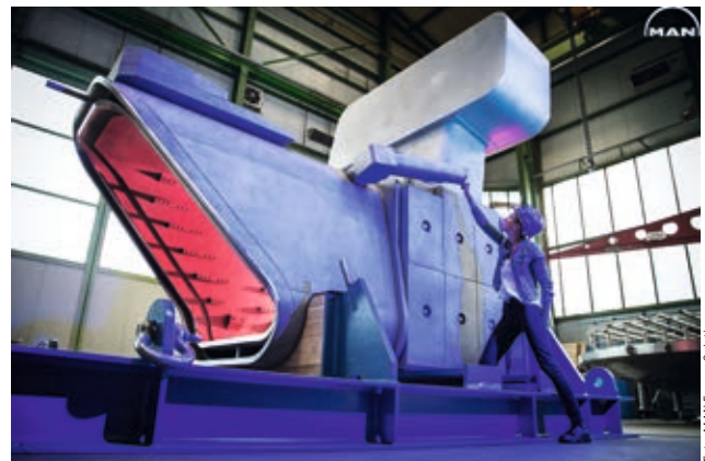
Zugangsstützen für den internationalen Experimentalreaktor ITER
