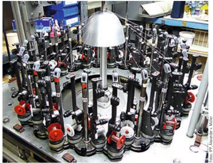
Herstellung eines Geflechts aus Wolframdraht
