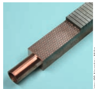
Mock-up einer plasmabelasteten Komponente mit einer Wärmesenke, welche auf einer mit Kupfer infiltrierten Wolfram-Wabenstruktur basiert
