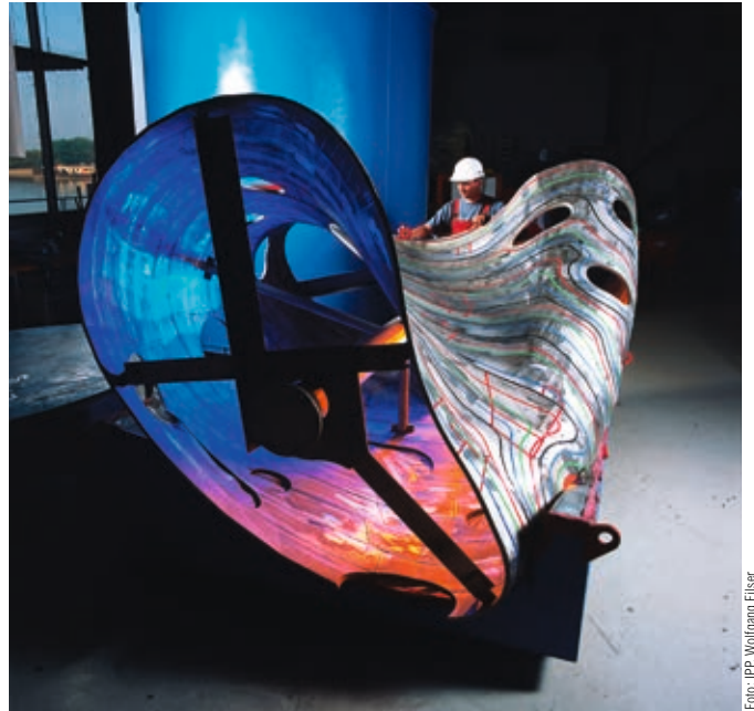
Innen- und Außenansicht des Plasmagefäßes von Wendelstein 7-X
