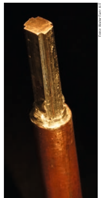
HTS CrossConductor mit zusätzlicher Kupfer-Ummantelung
