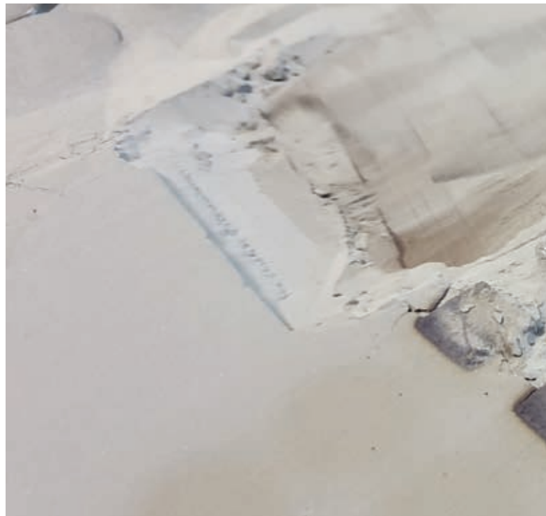
Additiv gefertigte Wolfram-Teile nach dem Herstellungsprozess bei der Entnahme aus dem Pulverbett
