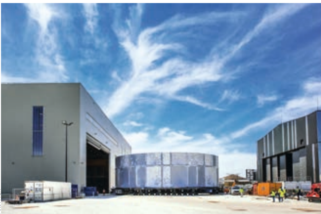
Beim Zusammenbau des ITER-Kryostaten – hier der „Upper Cylinder“ – stellen die Deggendorfer ihr Knowhow in komplexer Edelstahlverarbeitung erneut unter Beweis.
