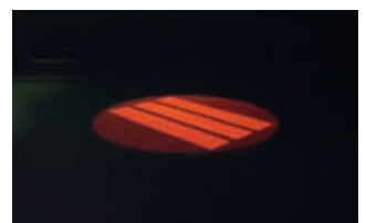
Vorgeheizte Bauplattform aus Wolfram während des additiven Herstellungsprozesses
