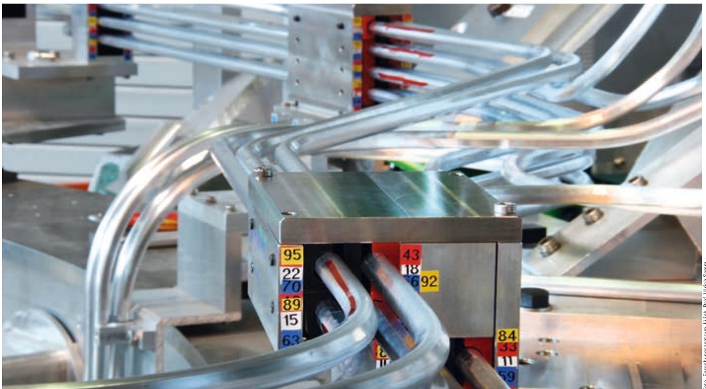
Geometrieprüfung der geformten Supraleiter
